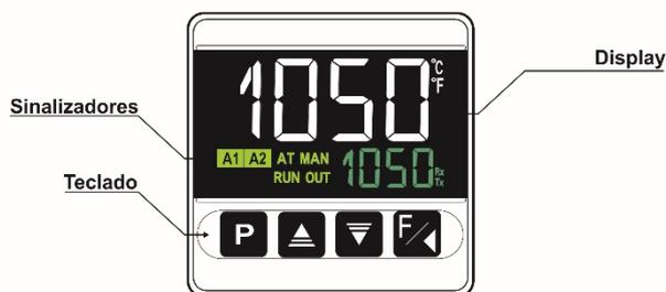
Figura 3 – Identificação das partes do painel frontal
